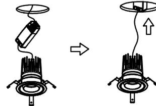
5. 将灯具的三个弹片往上折起来，然后把灯具往天花板开好的孔安装，让弹片卡住天花板，灯具无法脱落
